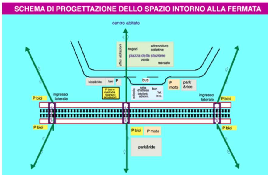
Nello schema di fermata riportato è evidenziata con dei rettangoli la posizione più corretta dei sottopassaggi di stazione, mentre le frecce verdi indicano il vantaggio dovuto al fatto che siano passanti, visto che permettono di allargare l'area da cui è possibile accedere direttamente in stazione.
